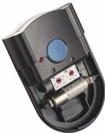
Bild 7: Der Rewiso Handsender in dem die Schwellwerte für Sonnen- und Windsensoren eingestellt werden können.
